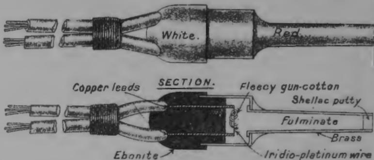
Fig. 2.      N° 14. Fuze, electric, Mark III.
